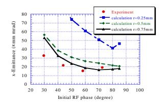
図 5 実験とシミュレーションでのエミッタンス の比較
