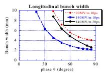
図 6 電子ビーム各パラメータの、RF 初期位相依存性をシミュレーションしたもの。実験での条件 (90MV/m、10ps、0.8nC/bunch) と、さらに高電界での条件を比較している。
