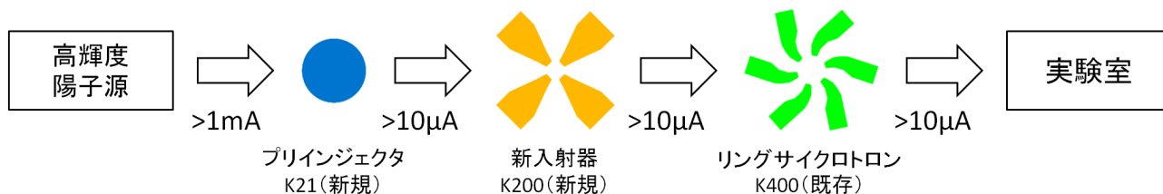
Figure 2: 将来的なサイクロトロンカスケード構成と目標ビーム電流
