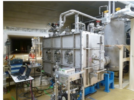
cERL 1.3 GHz Injector Cryomodule
