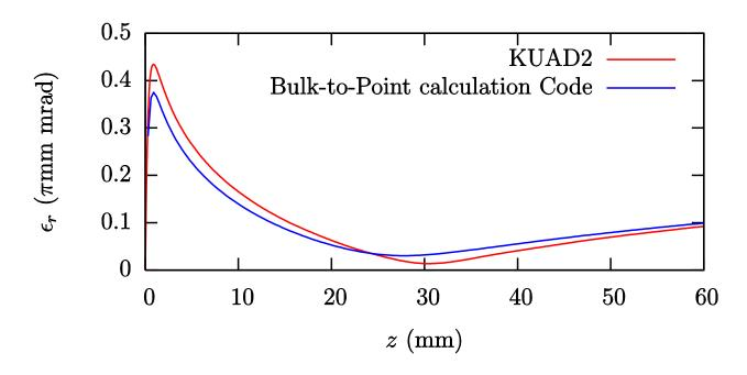
ある位置zを通過した粒子の積算により zでの規格化rmsエミッタンスを算出
