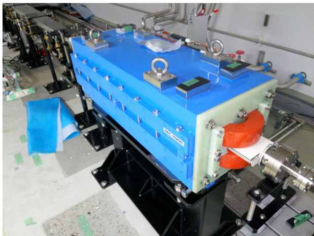
キッカー電磁石 (ヨーク長0.95 m, 最大磁場 0.9 T)
