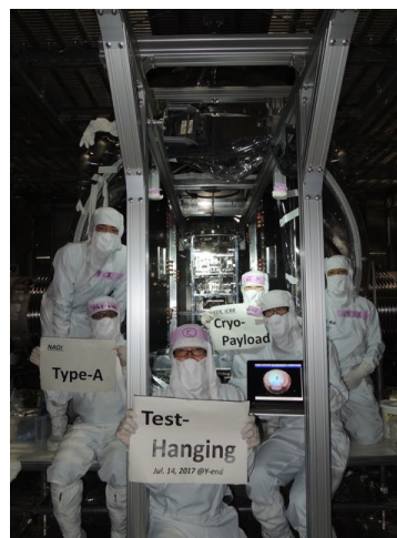
Figure 7: KAGRA サイトにおける極低温鏡懸架システムのインストールテスト。クライオスタット内に極低温鏡懸架システムのインストールが完了したところ。
