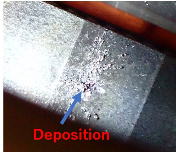
損傷したコリメータヘッド (ヘッド材質はタングステン)
