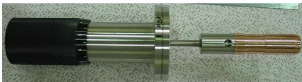
図8：チューナー（マルチコンタクト取付前）
