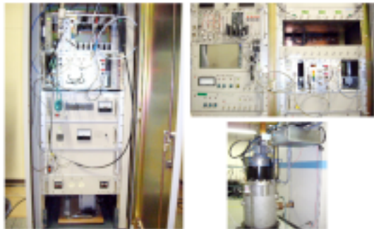
図.3 : 旧KLY_A-1励振系と新KLY_CT励振系
