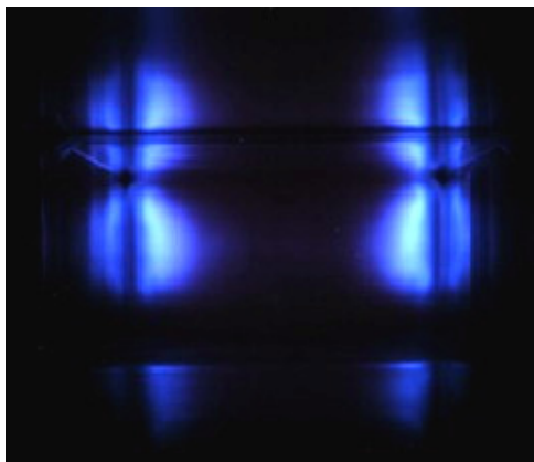
図7 高周波窓発光の様子(通過電力100MW)
