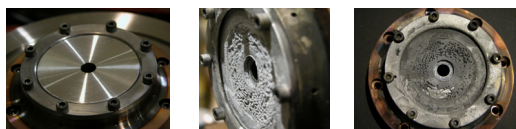
図5：使用したスパッタ電極の変化の様子。
