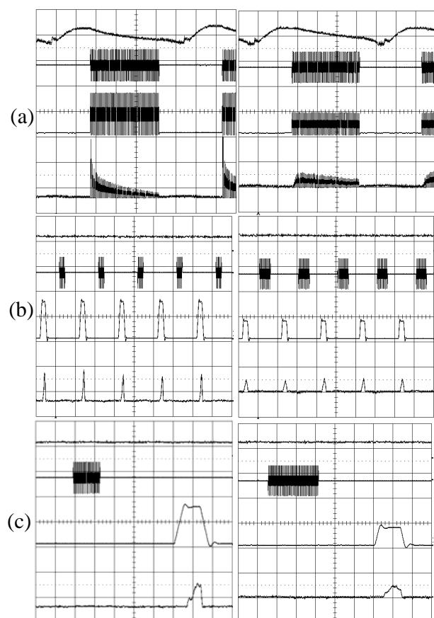
図4 . QAR法によるビーム取出し結果。右列はFQコイル電流を半分に、RFKO運転時間を2倍にした結果。各写真の下から、the spill structure, the FQ current, the RF-KO signal, the DCCT signal of the synchrotron. (a) whole structure with 0.5 s/div, (b) expansion of (a) at 130 ms from the extraction start (5 ms/div), (c) more expansion with 1 ms/div
