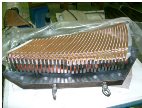
図 3: FFAG 入射器のスパイラル型磁極に取り付けられた FFAG 磁場生成用コイル。
