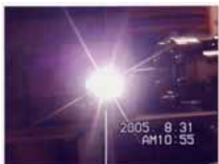
図1 試験運転時光モニターポート(BL20)で観測された1.4GeV電子からの放射光。
