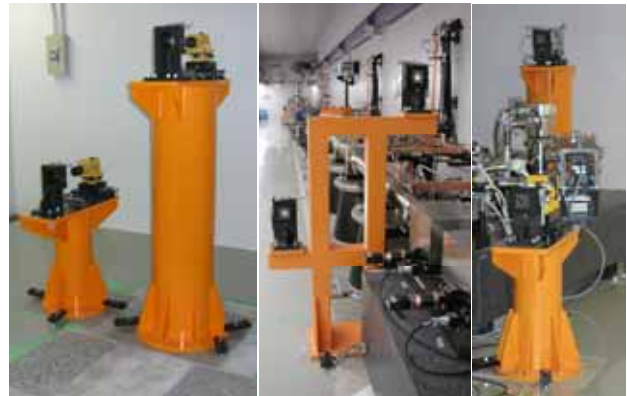
図4．基準線用十字線ターゲットと望遠鏡。 左から上流部、中間部、下流部。
