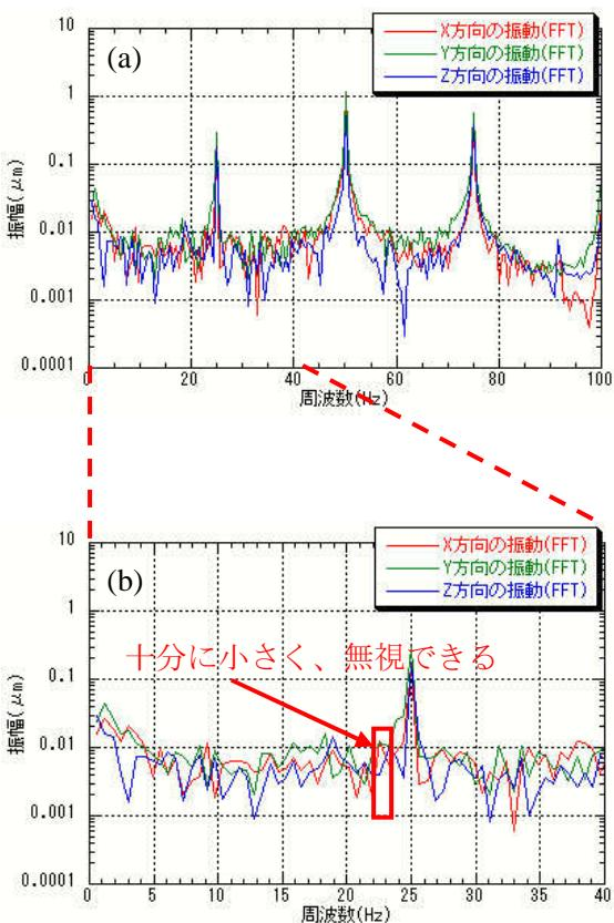
図6. X-Y-Z 方向振動測定結果(FFT 解析)
