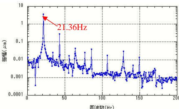
図3. FFT解析(アンダルの振動測定結果)
