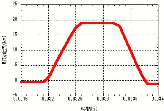
図4. 水平シフトバンプ電磁石励磁波形
