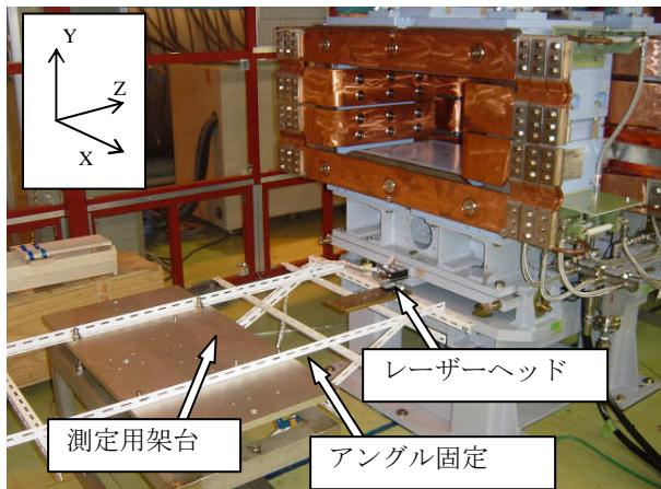
写真1. 水平シフトバンプ電磁石と測定装置
