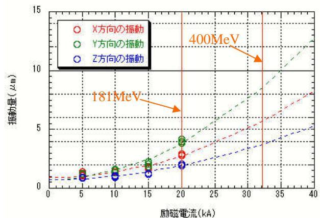
図7. 励磁電流と振動量の関係
