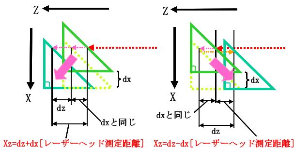
図1. X方向測定原理
