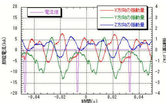
図5. X-Y-Z 方向振動測定結果
