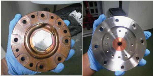
図3Mgカソード端板, カードリッジ型システム用端板
