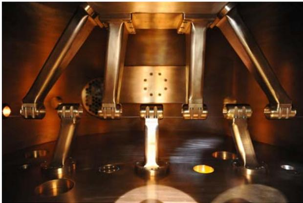
図5:ドリフトチューブ交換後のDTL3内部
