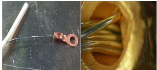
図 11 : シリコン被覆処理時の傷による断線
