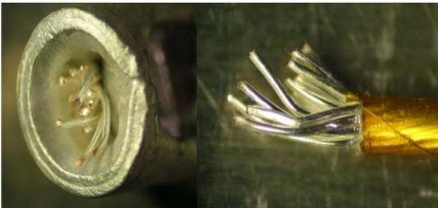
図 9 : カプトン線の断線部
