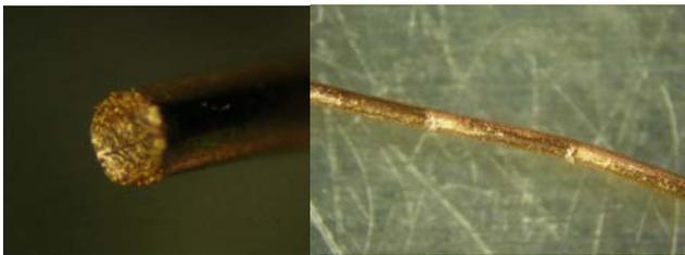
図4：銅単線の断線部と傷の状態
