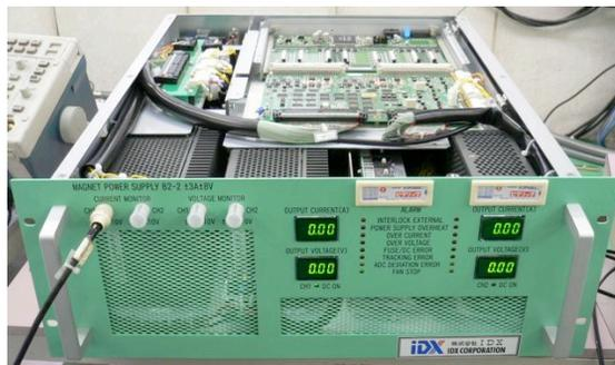
図6：2ch型電磁石電源
