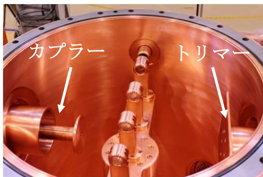
図5:組み立て中のDTL1の内部
