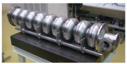
図9:1.3GHz9セル空洞試作1号機
