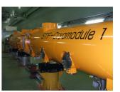
(a)地下トンネルへの搬入 (b)設置状況 図4:クライオスタットの搬入と設置の状況
