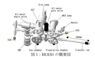
HUES1 は主にガンチェンバーとプリパレーションチェンバーで構成される。ガンチェンバーの持つ役割として最も重要な事は、極高真空下で光陰極の寿命測定を行うことである。そのために、ガンチェンバーを化学研磨されたチタンで製作した。チタンは一般的に真空容器製作の際に用いられるステンレスよりガス放出が 2~3 桁小さいとされている<sup>[3]</sup>。それと共に真空排気装置として、NEG ポンプ(12001/s)とクライオポンプ(27001/s)を使用する。
