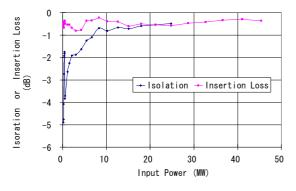
図3 単向管大電力試験結果 (パルス幅  $2.5 \mu$  sec, 繰り返し 10Hz)
