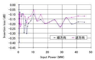
図 4 フェライト移相器大電力試験結果 (パル ス幅  $2.5 \mu$  sec, 繰り返し 10Hz)
