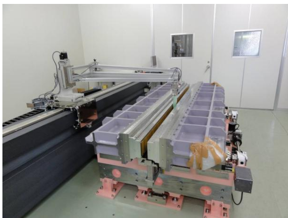
図 1: テラヘルツ光発生用アンジュレータの磁場測定の様子
