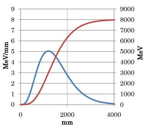
図3:グラファイトにビームエネルギー8GeVの電子ビームが入った場合の,エネルギー損失計算結果
