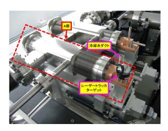
図 11:電子ビームスリット 1.45GeV 磁気シケイン型バンチ圧縮器分散部用
