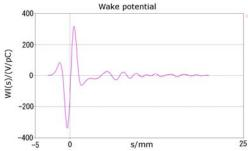
図9:ビーム軸方向航跡場解析結果 銅ロッド移動用開口 φ75mm
