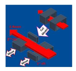
図2:電子ビーム基本構造
