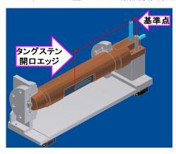
図 12: 銅ロッド, タングステンブロック構造体概略 図, 図 11 の A の部分。
