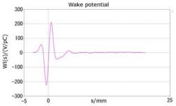
図 10: ビーム軸方向航跡場解析結果
