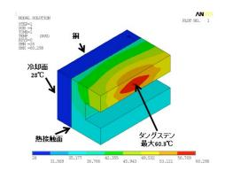
図 8: 熱解析結果, ANSYS<sup>[4]</sup>による解析。 接触熱コンダクタンス 5000W/m<sup>2</sup>/K
