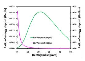
図5:電子のカスケードによるタングステン内 の付与エネルギー分布
