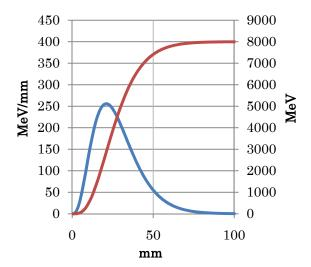
図4: タングステンにビームエネルギー8GeV の電子ビームが入った場合の,エネルギー損失計算結果
