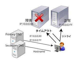
図 3: DNS ラウンドロビンを用いた冗長化概要
