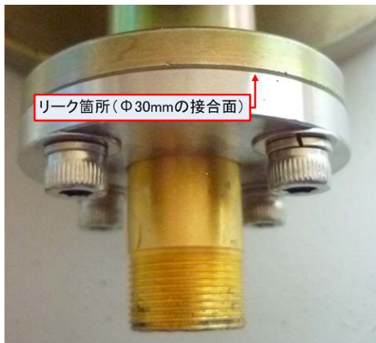
図5：PD チェンバーリーク箇所
