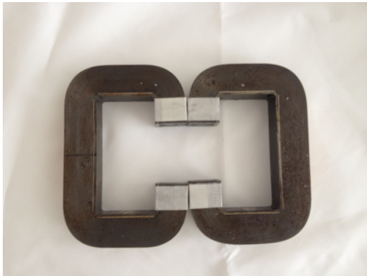
図 3: ナノ結晶構造を持つ高特性の磁性材料ファインメットを用いたキッカーコアの試作品。
