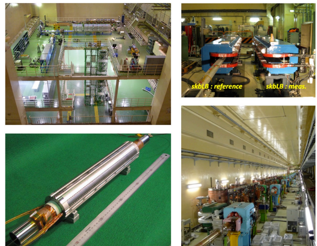
図 4: (左上) 大穂実験棟の真空作業デッキに設置された縦型コーティング装置 1 号機および新型ベーキング装置。(右上) LER 新偏向磁石のための磁場測定ベンチ。(左下) 超伝導 4 極磁石 (QC1P) R&D 機。(右下) HER から LER に移設された ARES 空洞。
